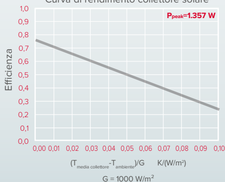
Curva di rendimento collettore solare
